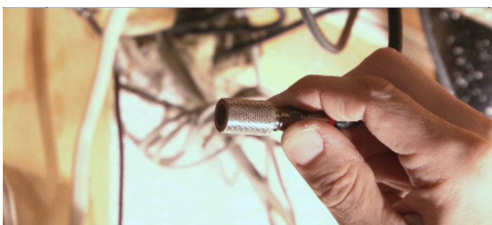
EL TONO ALTO IDENTIFICA LA SEÑAL DE TRANSMISIÓN DE LA LÍNEA
